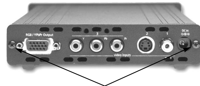
Tornillos del panel posterior
